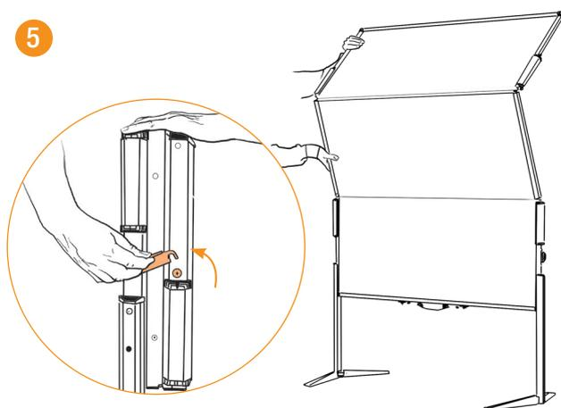
Sicherungshebel auf beiden Seiten lösen und Tafel aufklappen.
